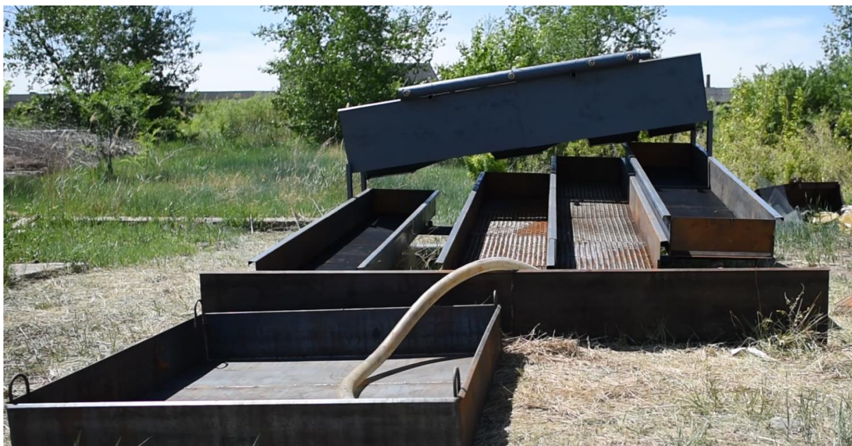
Фото 1. Приставка ГГШ с производительностью по пескам 60м 3 /час.
